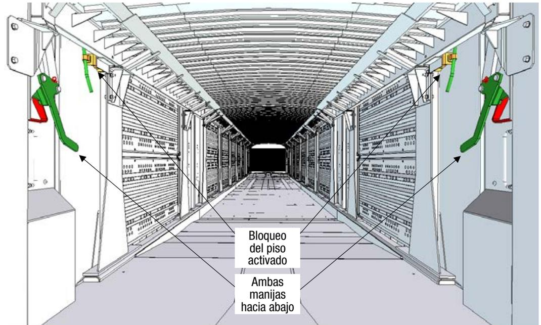
**1** Jale de la palanca de bloqueo del piso para liberar la manija de elevación del piso.
