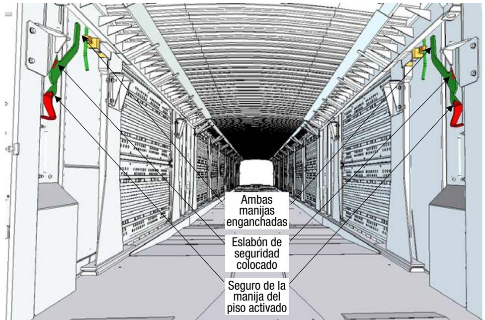
**1** Retire el eslabón de seguridad del gancho.
